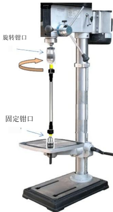
图7 扭转测试装置
