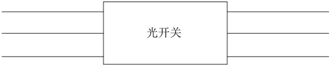
图10 配置 A，包含集成光纤尾纤且不带连接器的设备
