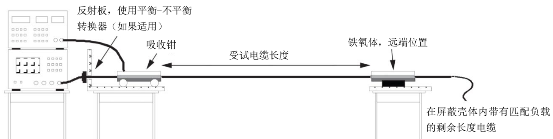
图10 对称电缆近端测量的试验装置
