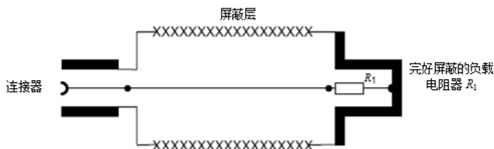
图3 同轴电缆试样的准备
